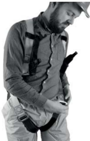
C) Schließen Sie die Beingurte, Einstellung und Aufhängungstest Der Gurt muss so eingestellt werden, dass er gut sitzt, um die Verletzungsgefahr im Falle eines Sturzes zu verringern.
