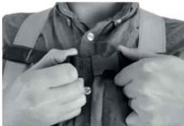
B) Presione ambas mitades de las hebillas hasta que oiga un clic. Tire de las dos mitades de las hebillas para asegurarse de que están firmemente conectadas. Tire del extremo suelto de la correa para tensarla. A continuación, deslice el cierre rígido (solo en la correa pectoral) hasta la hebilla para reducir el desajuste de la banda. Meta el exceso de cinta en los cierres elásticos.
